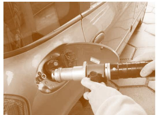
Die Befüllung Erdgasfahrzeugs erfolgt über ein Ventil neben dem Benzintank.
